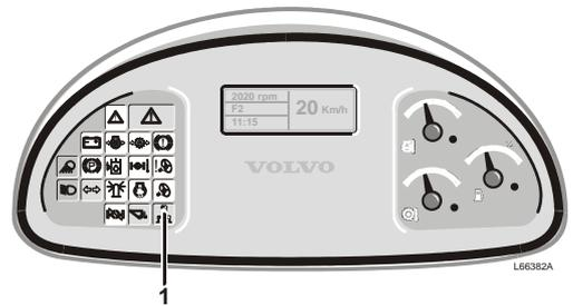
شکل 18 پانل تجهیزات (لوازم اندازه گیری) میانی
